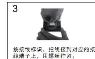
按接线标识，把线接到对应的接线端子上，用螺丝拧紧。
