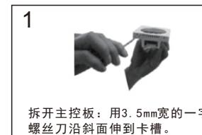
拆开主控板：用3.5mm宽的一字螺丝刀沿斜面伸到卡槽。
