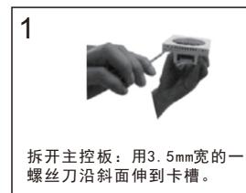
拆开主控板：用3.5mm宽的一字螺丝刀沿斜面伸到卡槽。
