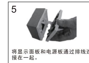
将显示面板和电源板通过排线连接在一起。
