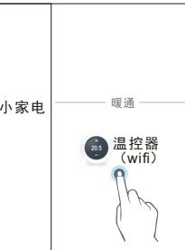
3、在开机状态下，长按温控器开机键5秒后，出现WiFi图标闪烁。
