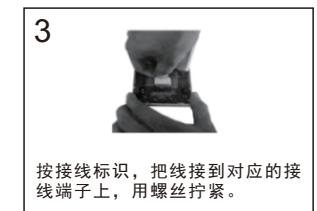
按接线标识，把线接到对应的接线端子上，用螺丝拧紧。
