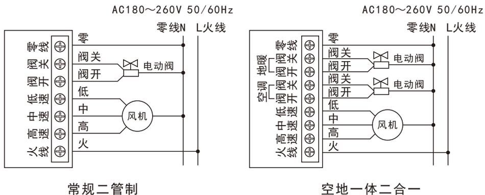
注：若现场使用常闭两线阀，只需接“阀开”端子即可；没阀的，“阀开”和“阀关”都不用接。
