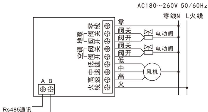
注：若现场使用常闭两线阀，只需接“阀开”端子即可；没阀的，“阀开”和“阀关”都不用接。
